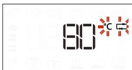
Нажмите или , чтобы подтвердить значение и начать процесс приготовления. В процессе приготовления на дисплее отображается итоговая температура термощупа. Когда температура мяса достигает заданного итогового значения, цикл приготовления останавливается и на дисплее выводится надпись "End" ("Конец").
