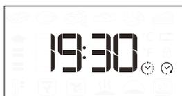
Примечание: Установка отложенного старта отменяет стадию предварительного прогрева духовки. Поскольку духовка выходит на заданную температуру постепенно, время приготовления окажется немного длиннее, чем указано в таблице приготовления.
