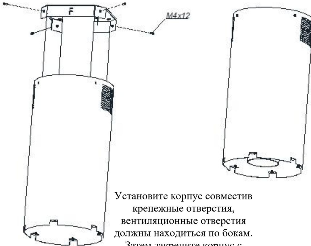
Установите корпус совместив крепежные отверстия, вентиляционные отверстия должны находиться по бокам. Затем закрепите корпус с помощью винтов М4х12 мм
