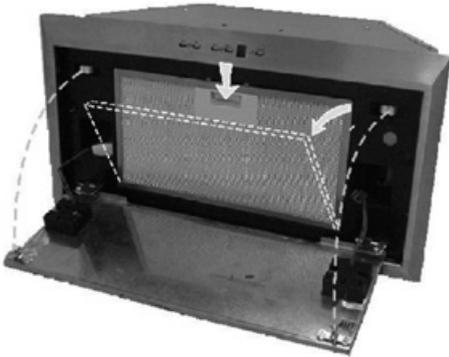
Угольные фильтры следует менять через каждые 120 часов наработки вытяжки, о чем напоминает мигающий сигнал «Загрязнение фильтра» на дисплее **L** (см. рис. 3). Угольные фильтры устанавливаются на защитные решетки корпуса мотора путем легкого поджатия и поворота их по часовой стрелке. Для снятия угольного фильтра его следует также слегка поджать и повернуть против часовой стрелки.
