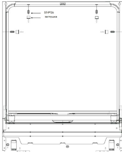
В обшивке посудомоечной машины с правой и левой стороны, а также сверху имеются 4 отверстия. Для крепления посудомоечной машины к кухонному модулю используйте деревянные винты ST4\*26 (соответствующие самонарезающие винты).
