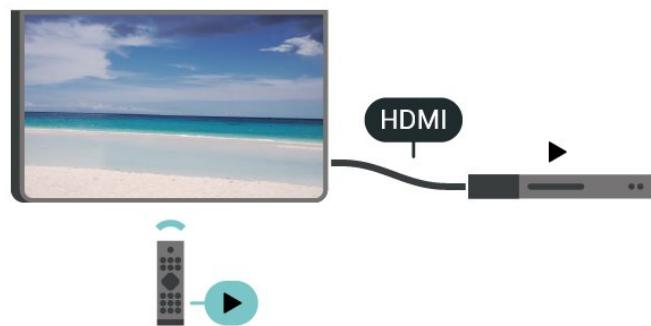
Для этого необходимо включить в телевизоре и на подключенных устройствах функцию HDMI CEC (Consumer Electronic Control).
