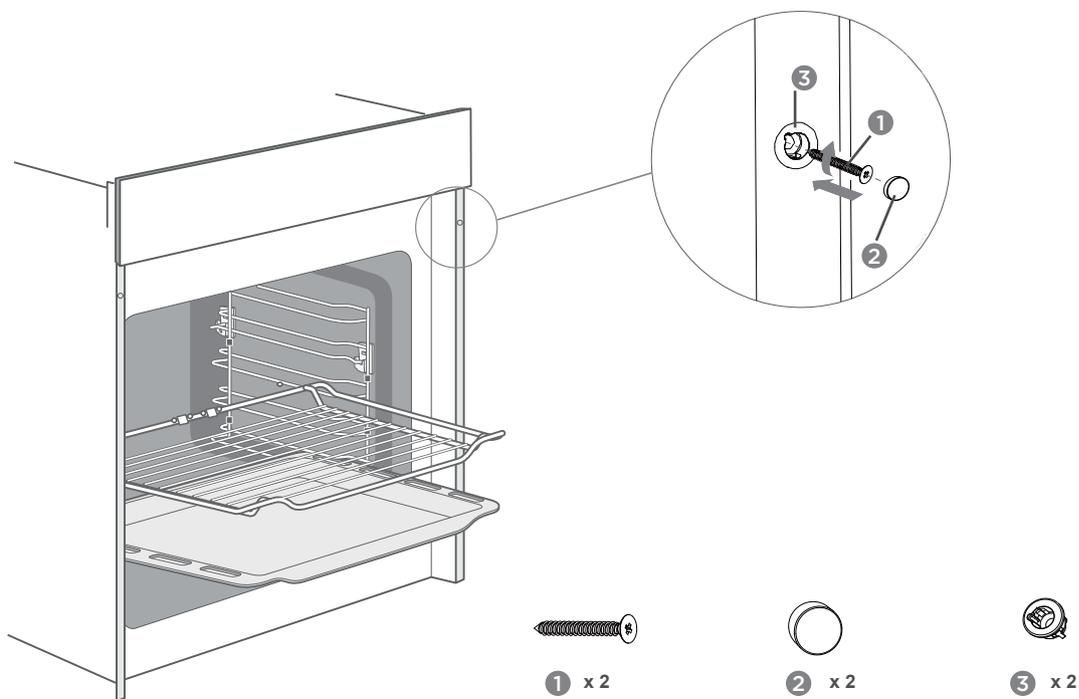
После того как устройство будет размещено на месте установки, закрепите его с помощью винтов (наличие винтов в комплекте опционально и не гарантируется производителем).
