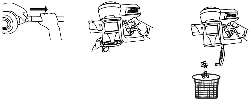
Рис. 10. Порядок быстрой очистки контейнера - пылесборника
