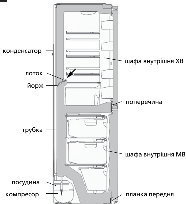
Рисунок 10 – Схема зливу талої води
