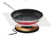
Индукционный нагрев обеспечивается электромагнитным полем. Индукционная катушка внутри плитки создает электромагнитное поле, которое вызывает нагрев посуды, стоящей на поверхности плитки. Исходя из природы процесса нагрева, существуют требования к посуде, применяемой для индукционных плиток. Во время нагрева индукционная плитка может создавать определенные шумы:
