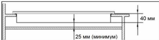
**ВАЖНО:** Между нижней частью устройства и любой поверхностью, расположенной непосредственно под ней, необходимо оставить зазор не менее 25 мм.
