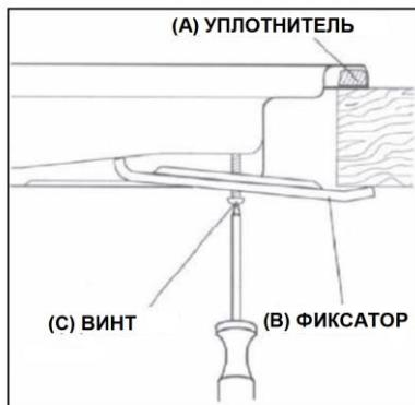
**(A)** Уплотнитель ; **(B)** Фиксатор; **(C)** Винт
