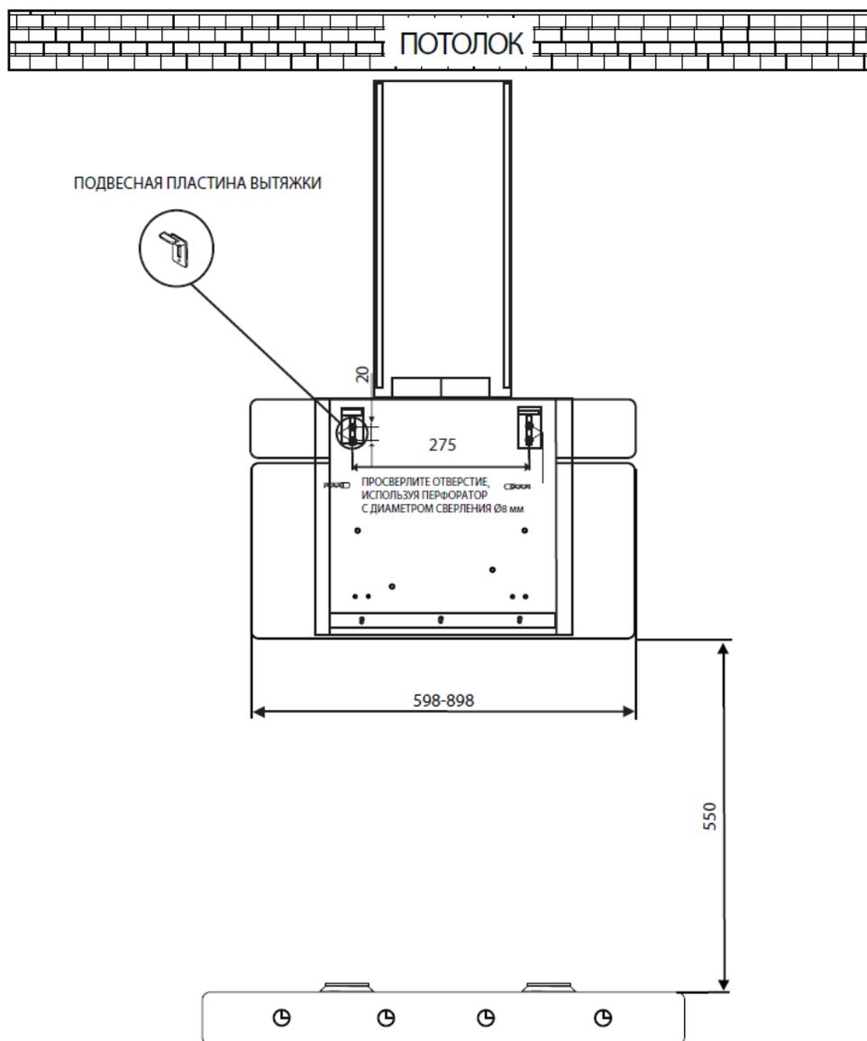
2. Просверлите по 2 отверстия под каждую пластину крепления.
