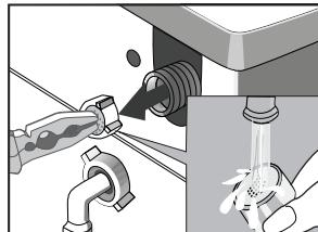
**Примечание:** рекомендуется сначала произвести чистку фильтра со стороны крана подачи воды, только затем – чистку фильтра со стороны стиральной машины.
