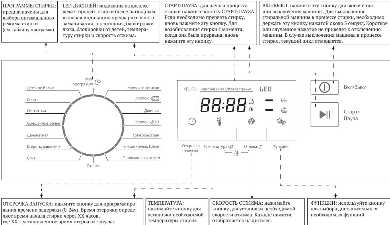
**Примечание:** панель управления является типовой и может отличаться в различных моделях стиральных машин. Используйте ее только для справки – производитель оставляет за собой право изменять внешний вид и характеристики прибора без дополнительного уведомления.
