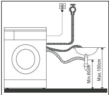
**Примечание:** фиксируйте шланг должным образом, чтобы он не был погружен в воду, чтобы вода не попадала на поверхность пола. Если шланг сброса воды слишком длинный, не пытайтесь засунуть часть шланга внутрь стиральной машины, т.к. это может создавать шум во время работы. Не рекомендуется использовать удлинительные шланги. При необходимости, удлинение должно иметь такой же диаметр, что и оригинальный шланг, и его длина не должна превышать 150 см.
