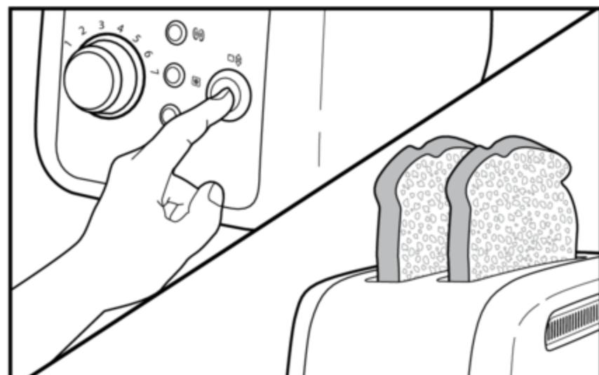
**4** Вы можете остановить процесс разогрева в любое время, снова нажав кнопку Поджаривание/Отмена ( ). Тостер поднимет тосты и выключится.
