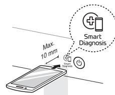
**3** Нажмите и удерживайте кнопку **Temp.** (**Температура**) в течение не менее 3 секунд, одновременно держа микрофон смартфона около логотипа до полной передачи данных.
