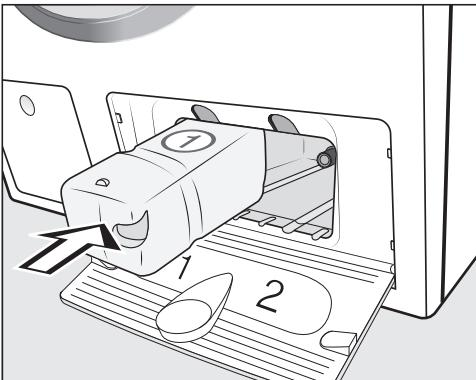
■ Задвиньте картриджи с моющим средством для **UltraPhase 1** в отсек 1 до защёлкивания фиксатора.
