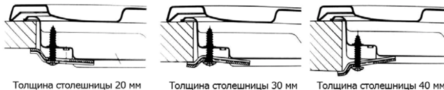
Рис. 6. Положение крепёжных скоб в зависимости от толщины столешницы
