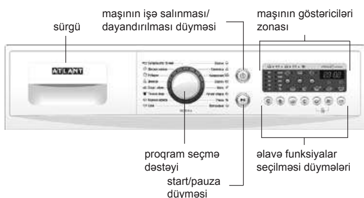
Şəkil 1 – İdarə lövhəsi
