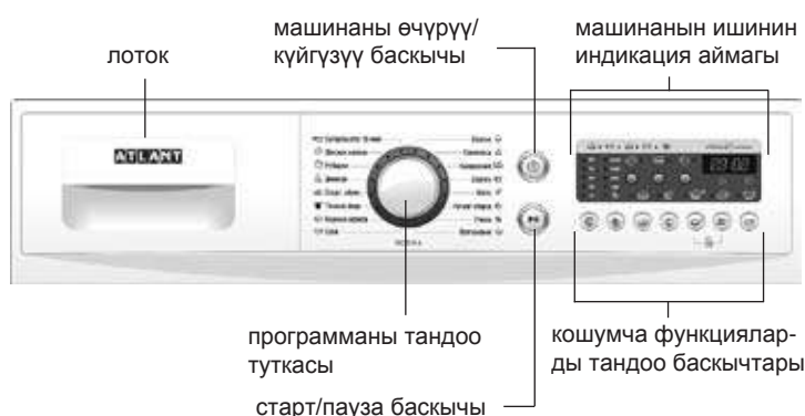
1-сүрөт — Башкаруу панели
