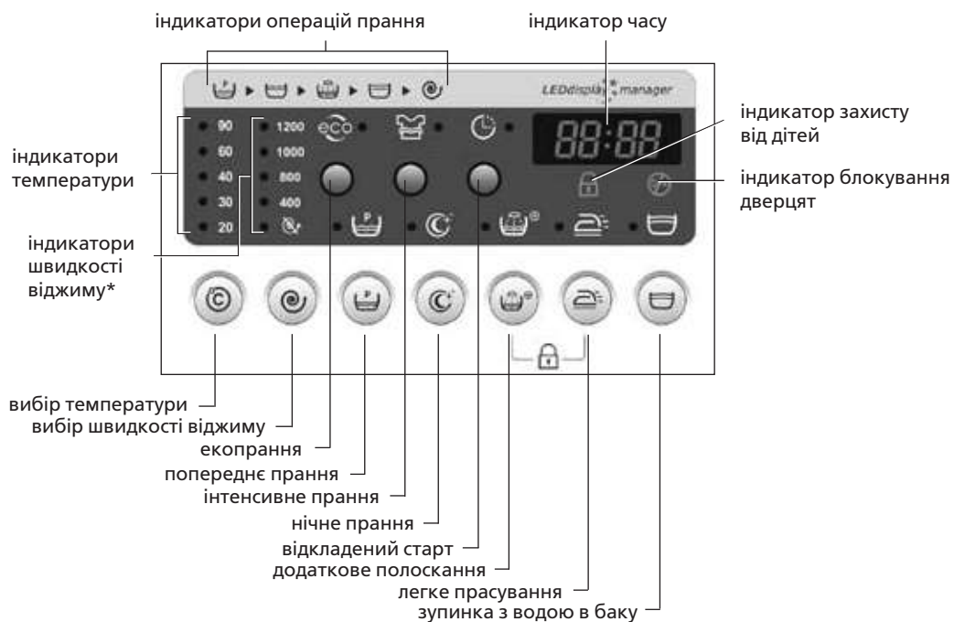
Рисунок 3 – Зони індикації і кнопки вибору додаткових функцій
