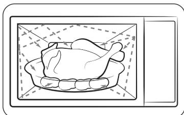
1. Магнетронды түтіктен шыққан микротолқын, бұрылмалы табақтың үстінде айналып тұрған тағамға біркелкі таралады. Сондықтан да, тағам біркелкі піседі.
