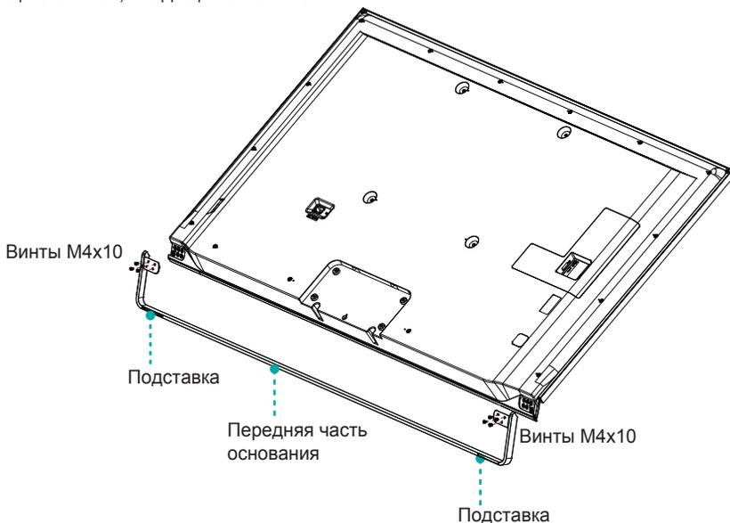
4. Извлеките заднюю часть основания, расположите ее так, чтобы сторона с подставкой была с вашей стороны, а затем закрепите деталь на телевизоре при помощи 6 винтов, входящих в комплект, а затем установите на место защитную панель (крепление на магните)
