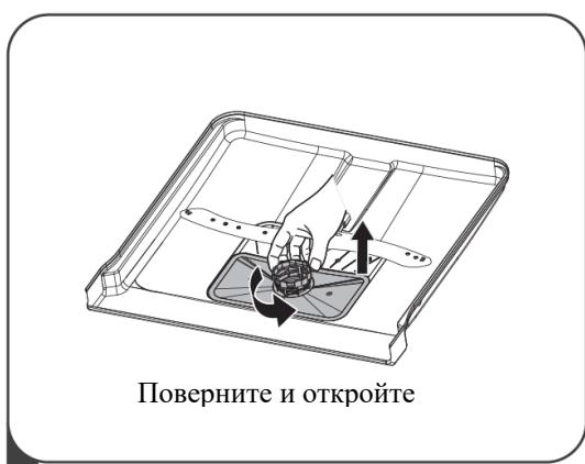
1 Возмитесь за фильтр грубой очистки и поверните его против часовой стрелки, чтобы разблокировать. Поднимите фильтр вверх и выньте его из места крепления.
