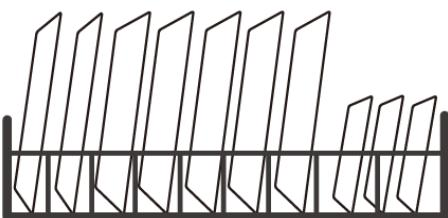
Рекомендуемый максимальный диаметр перед дозатором моющего средства, составляет 19 см, чтобы не затруднять его открытие.
