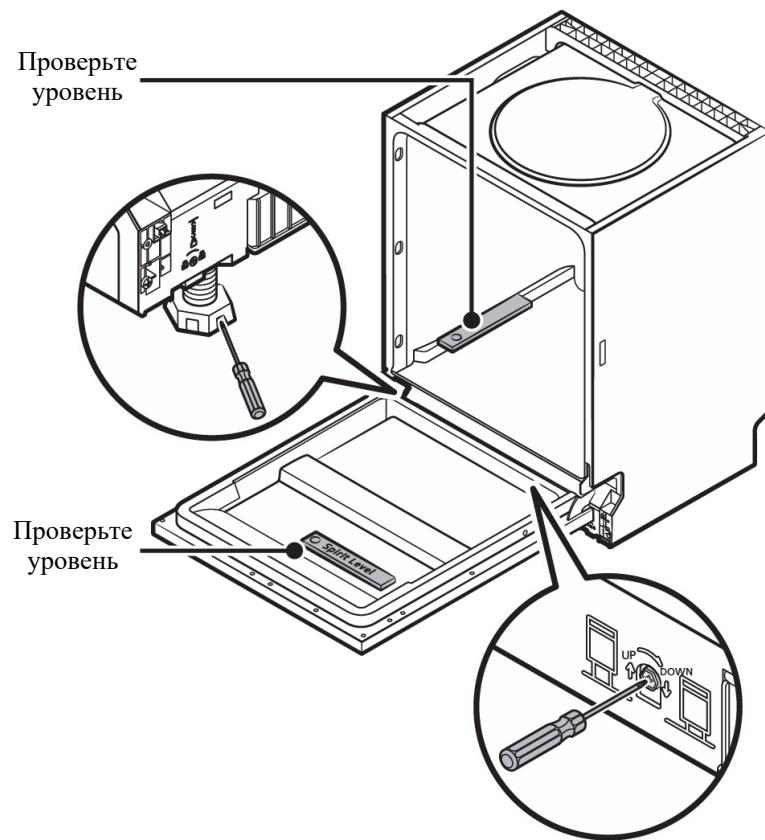
**Примечание:** Максимальная высота регулировки ножек составляет 50 мм.
