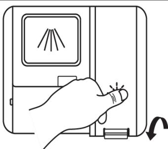
3 Закройте крышку резервуара ополаскивателя
