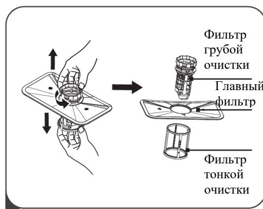
2 Фильтр тонкой очистки можно снять с нижней части фильтра в сборе. Фильтр грубой очистки можно отсоединить от главного фильтра аккуратно сжимая язычки в верхней части и вытащить его.
