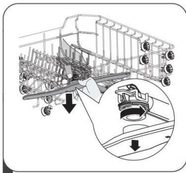
1 Чтобы снять верхний распылитель, удерживайте гайку и поверните по часовой стрелке, чтобы снять его.
