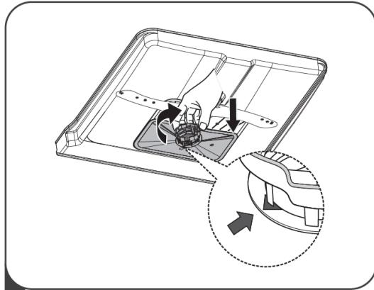
4 После очистки, соберите части фильтра в обратном порядке. Установите фильтр в место крепления и поверните по часовой стрелке для фиксации.
