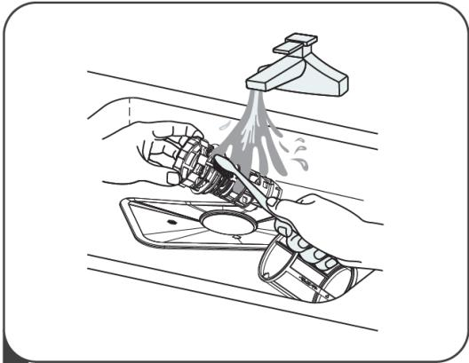
3 Более крупные остатки пищи могут быть очищены путем промывки фильтра под проточной водой. Для более тщательной очистки используйте мягкую щетку
