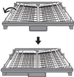
Поднимите левую сторону корзины вверх и установите ее в более низкое положение. Левая сторона корзины будет находиться в более низком горизонтальном положении, а правая под наклоном.
