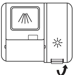
1 Снимите крышку резервуара ополаскивателя, потянув ее вверх.
