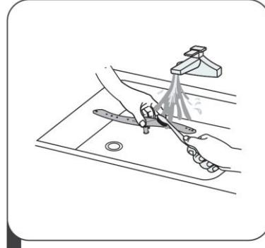
3 Используйте мягкую щетку для очистки форсунок распылителей, после очистки установите их на места крепления.
