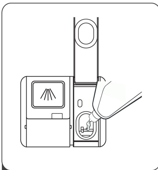
2 Осторожно влейте ополаскиватель в дозатор, не допуская его переполнения.
