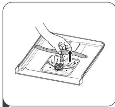
2 Чтобы снять нижний распылитель, просто потяните его вверх и аккуратно извлеките из посудомоечной машины.
