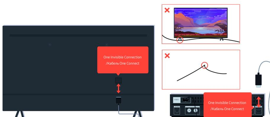
Если устранить проблему не удастся и для ТВ используется One Invisible Connection или Кабель One Connect, отсоедините и снова подключите One Invisible Connection или Кабель One Connect к ТВ и приставке One Connect. Убедитесь, что One Invisible Connection или Кабель One Connect не защемлен и не перегнут.
