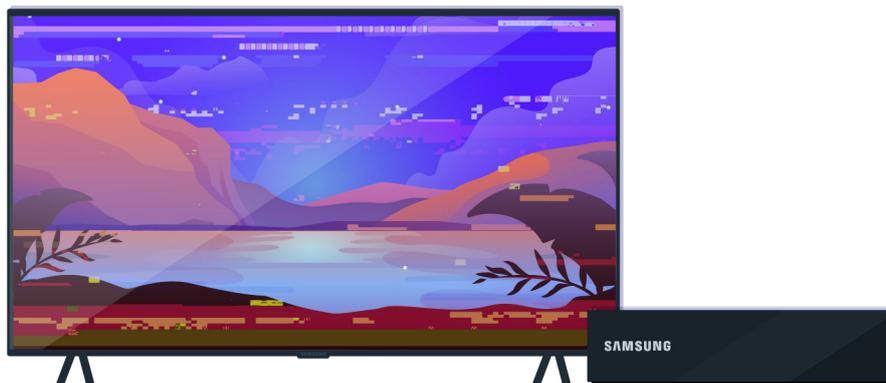
Проверьте подключение антенны и кабеля входного сигнала.
