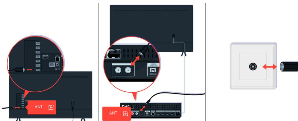
Проверьте подключение антенны и кабеля входного сигнала.
