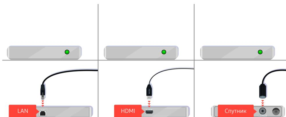
Если используется телеприставка, проверьте кабельное соединение. Кабель, который нужно проверить, зависит от типа приставки.
