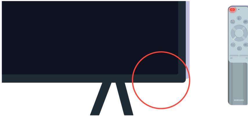
Если при нажатии кнопки питания датчик пульта ДУ отключается, ТВ подключен к источнику питания правильно.
