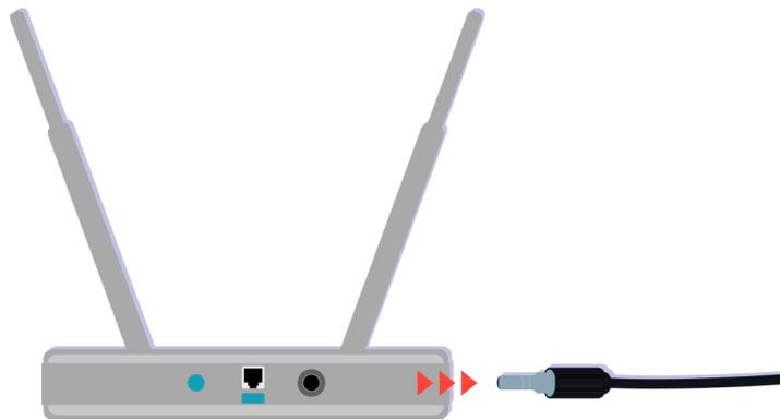
Попробуйте перезагрузить точку доступа, отсоединив и снова подсоединив шнур питания. Перезагрузка может занять 1–2 минуты.
