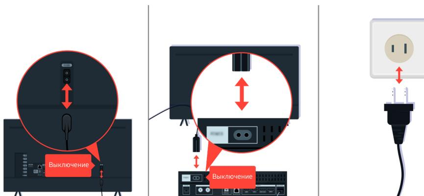
Отсоедините и снова подключите кабели питания и кабели HDMI с обратной стороны ТВ или приставки One Connect, затем извлеките кабель питания из розетки и снова подключите его.
