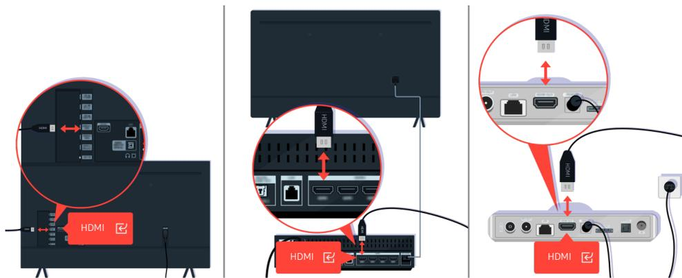
Проверьте подключение антенны и кабеля HDMI.
