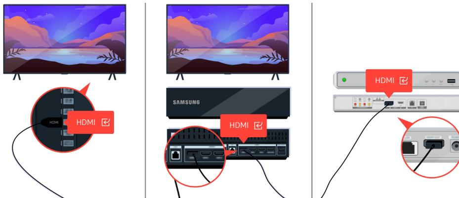
Если проблема не исчезает, попробуйте подключить к ТВ другое устройство с помощью кабеля HDMI. Если изображение на экране нормальное, неисправность связана с внешним устройством.
