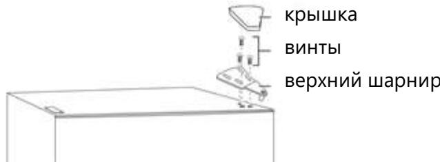
2. Снимите дверь морозильной камеры.
