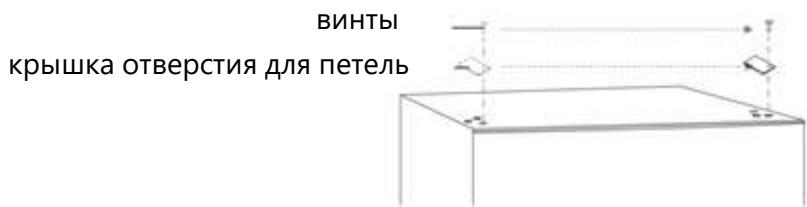
11. Закрепите верхний шарнир в верхней левой части шкафа тремя винтами, которые вы удалили ранее. Перед тем, как затягивать винты верхнего шарнира, убедитесь, что верхняя часть двери находится на одном уровне с корпусом, а резиновая прокладка обеспечивает хорошее уплотнение.
