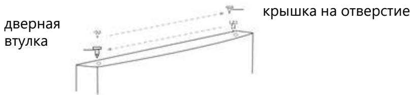
17. Удалите винт, который крепит крышку отверстия для винта шарнира в верхней левой части корпуса, снимите крышку и закрепите крышку в верхней правой части корпуса.
