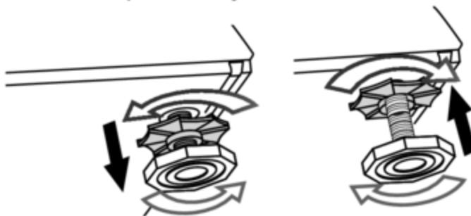
3. Затем вручную затяните все контргайки.
