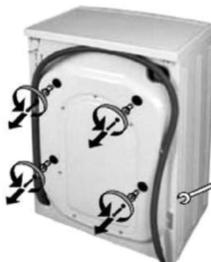
**!** Перед эксплуатацией стиральной машины выньте транспортировочные болты!
