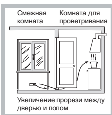
Примеры вентиляционных отверстий для воздуха горения
