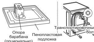
Снимите транспортировочные болты и опоры.
