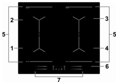
1. Индукционная зона нагрева, макс. 2000 Вт, Power Boost макс 2600 Вт
