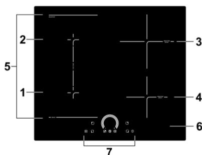
1. Индукционная зона нагрева, макс. 2000 Вт, Power Boost макс 2600 Вт
