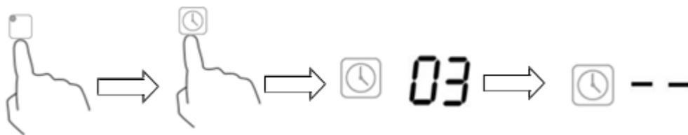
4. После настройки таймера начнется обратный отсчет. Дисплей таймера будет отображать остаток заданного времени.
