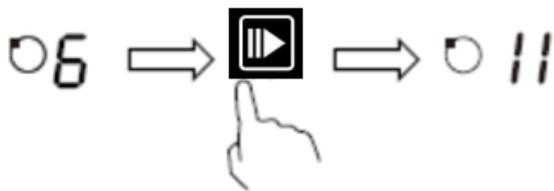
4. Чтобы выйти из режима паузы, нажмите на кнопку STOP&GO , затем варочная зона вернется на тот режим мощности, который был установлен перед переходом на паузу.
