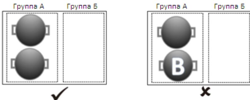
2. Коснитесь иконки варочной зоны, для которой Вы хотите включить функцию Power Boost, индикатор, следующий за кнопкой, загорится на 5 секунд.
