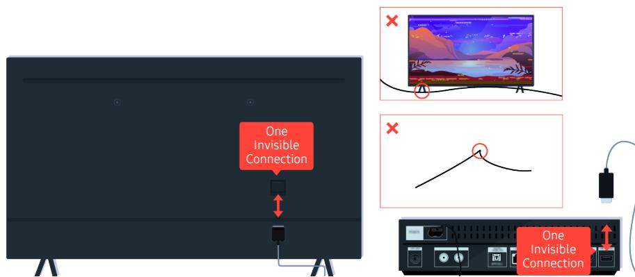
Если устранить проблему не удается и ваш телевизор использует One Invisible Connection, отсоедините и снова подсоедините кабель One Invisible Connection к телевизору и приставке One Connect. Убедитесь, что кабель One Invisible Connection не защемлен и не перегнут.
