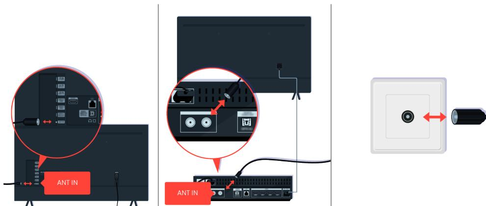
Проверьте подключение антенны и кабеля входного сигнала.
