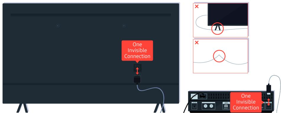
Отсоедините и снова подсоедините кабель One Invisible Connection, которым телевизор подключен к приставке One Connect (OC). Убедитесь, что кабель One Invisible Connection не защемлен и не перегнут.
