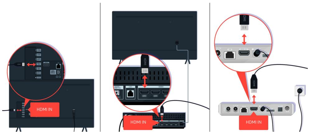
Проверьте подключение антенны и кабеля HDMI.
