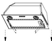
Надежно закрепите корпус вытяжки к шкафчику 12 винтами.
