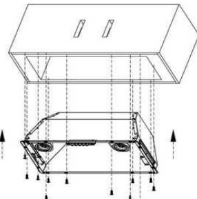
Проверьте и убедитесь, что корпус вытяжки надежно установлен и закреплен. Затем, присоедините нижнюю часть корпуса, которую открутили ранее с помощью 4 винтов.
