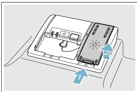
2. Заполнить ополаскиватель до отметки «max».
