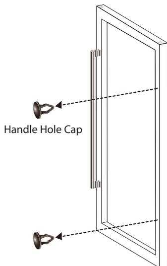
**6.** Аккуратно потяните уплотнитель дверцы в одну сторону, чтобы обнаружить винты ручки (2шт) на левой стороне дверцы. Открутите их крестовой отверткой и снимите ручку (шайбы оставьте на месте).
