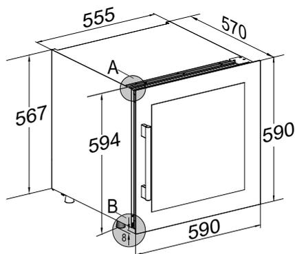
Чтобы закрепить прибор в шкафу, вкрутите 4 винта (ST4.2\*12 мм) в верхний кронштейн. Верхний кронштейн предварительно установлен на верхней части прибора.
