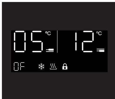
Окно дисплея можно установить в выключенное положение, чтобы оно выглядело менее навязчиво. Ваш прибор будет продолжать работать, но окно дисплея не будет видно. Вы можете проверить температуру в винном холодильнике, нажав кнопку питания.
