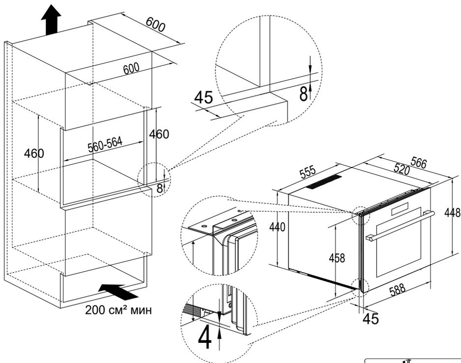
Для более надежной фиксации прибора можно установить дополнительную верхнюю монтажную планку (которая входит в комплект поставки прибора) на верхней стороне прибора и прикрутить ее к кухонному шкафу. См. правый рисунок.
