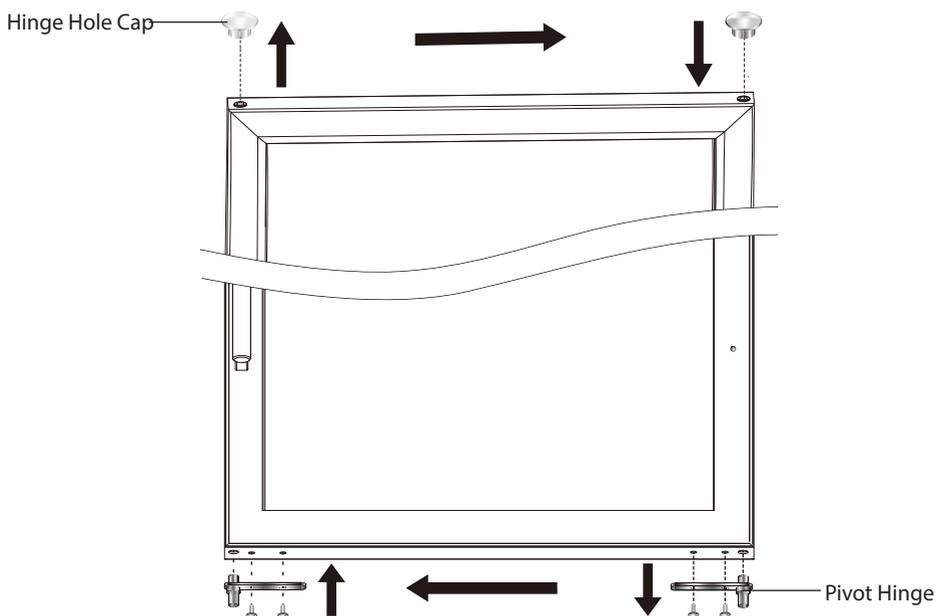
**3.** Снимите крышку нижнего шарнира, аккуратно поддев ее маленькой плоской отверткой. Снимите нижнюю петлю, открутив винт с шестигранной головкой (4шт). Открутите винт с цилиндрической головкой (4шт) с левой нижней стороны. Теперь переместите нижнюю петлю на левую нижнюю сторону и плотно закрутите ее винтами с шестигранной головкой (4шт). Переместите винт с шестигранной головкой
