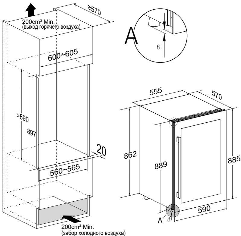
Чтобы закрепить прибор в шкафу, вкрутите 3 винта (ST4.2\*12 мм) в верхний кронштейн. Верхний кронштейн предварительно установлен на верхней части прибора.
