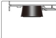
o Наклоните прибор примерно на 60°, чтобы обеспечить доступ к регулируемым ножкам.
