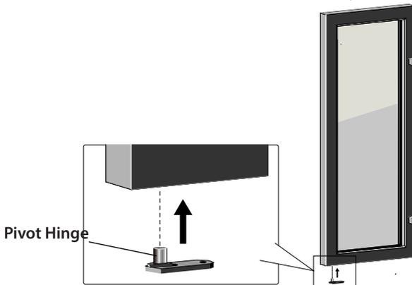
12. Установите дверь на левую сторону петли, затянув поворотный шарнир 2 винтами
