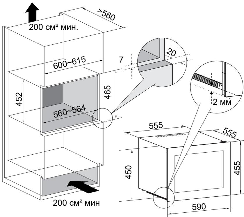
Чтобы закрепить прибор в шкафу, вкрутите 4 винта (ST4.2\*12 мм) в верхний кронштейн. Верхний кронштейн предварительно установлен на верхней части прибора.
