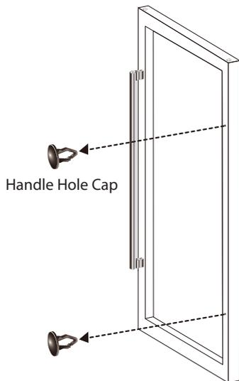
**8.** Аккуратно потяните уплотнитель дверцы в одну сторону, чтобы обнаружить винты ручки (2шт) на левой стороне дверцы. Открутите их крестовой отверткой и снимите ручку (шайбы оставьте на месте).
