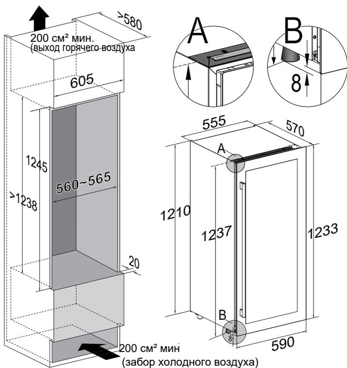
Чтобы закрепить прибор в шкафу, вкрутите 3 винта (ST4.2\*12 мм) в верхний кронштейн. Верхний кронштейн предварительно установлен на верхней части прибора.
