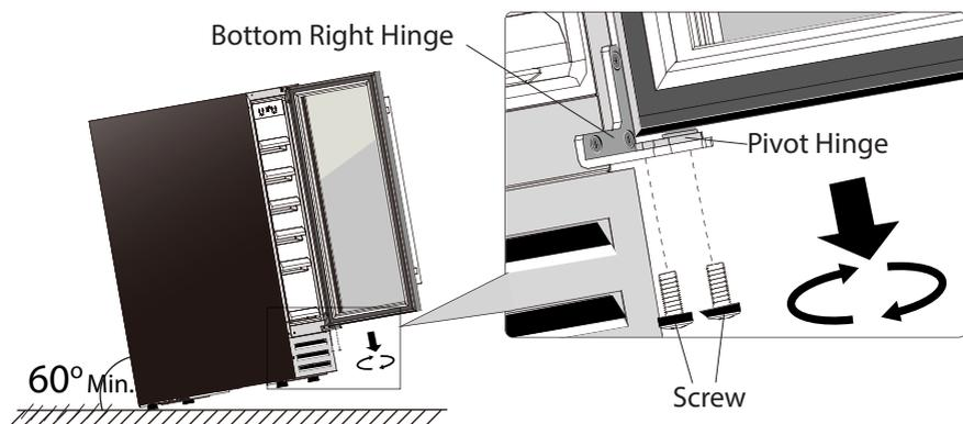
2. Осторожно снимите дверцу с верхней правой петли, чтобы не поцарапать ее. Выньте поворотный шарнир из отверстия дверной петли.
