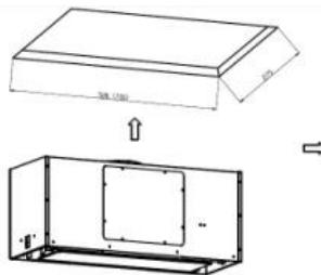
Просверлите прямоугольное отверстие 500 \* 275 мм в шкафу, переместите 2 крепежных элемента внутрь на максимальное расстояние, затем установите вытяжку в прямоугольное отверстие (зажимные части при этом должны быть выше, чем панель шкафа), затем сдвиньте крепежный элемент к внешнему краю.
