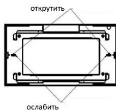
Открутите винты, расположенные снаружи крепежного элемента. Слегка ослабьте винты, расположенные внутри крепежного элемента.
