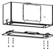
Открутите 4 винта от стеклянной панели, после чего снимите её.
