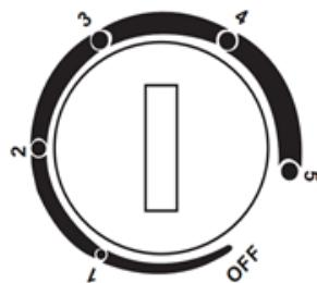
Температура морозильной камеры регулируется с помощью ручки, установленной на термостате. Цифры указанные на термостате «1, 2, 3, 4, 5» не обозначают конкретную температуру. Чем меньше цифра, тем выше температура:
