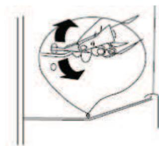
Чтобы избежать попадания талой воды внутрь холодильника, периодически очищайте дренажное отверстие в задней части холодильника. Используйте очиститель для очистки отверстия, как показано на картинке.
