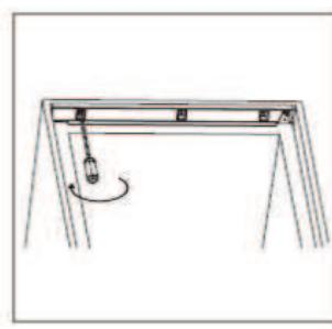
7. Установите четыре направляющих с ползунками и закрепите их короткими винтами. Затем закрепите накладки направляющих.
