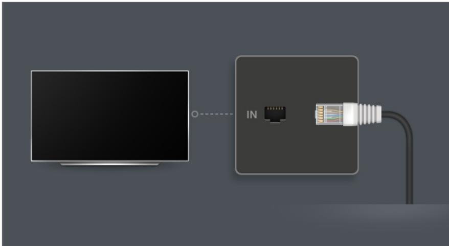
01 Подключите маршрутизатор к порту ЛВС телевизора с помощью кабеля ЛВС. Маршрутизатор необходимо предварительно подключить к Интернету.
