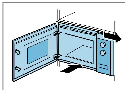
3. Dokręcać urządzenie, aż zostanie wyśrodkowane.
