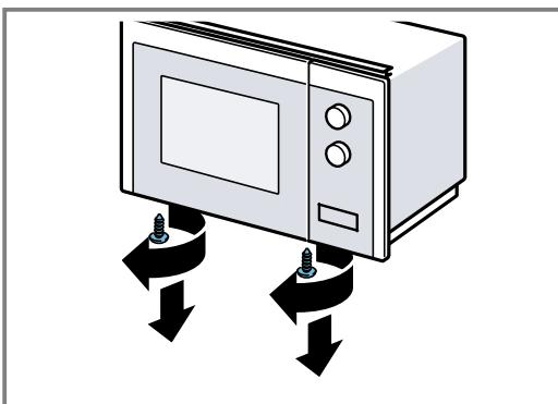
5. Za pomocą dwóch śrub zewnętrznych przymocować ramę montażową do dna kuchenki mikrofalowej.
