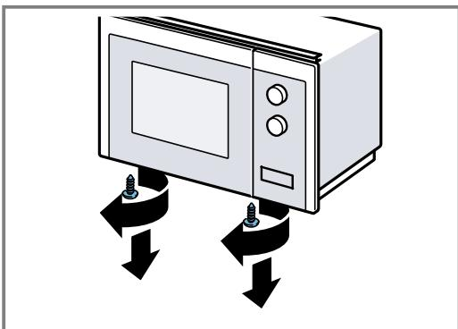
5. Rögzítse a mikrohullámú sütő alján a beépítő keretet a két külső csavarral.
