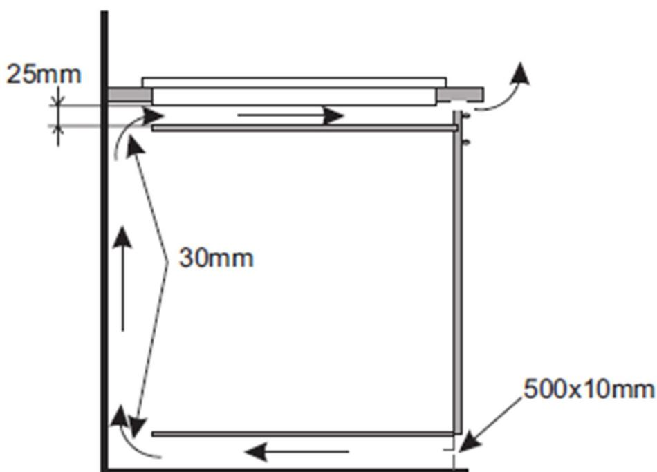
**i** Под низом столешницы надо оставить не менее 25 мм свободной поверхности – это необходимо для обеспечения циркуляции воздуха и во избежание перегрева поверхности вокруг кухонной плиты.
