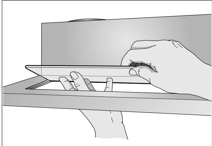
**Установка металлического жироулавливающего фильтра**
