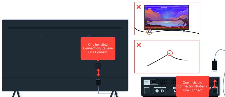
Если устранить проблему не удается и для телевизора используется One Invisible Connection или Кабель One Connect, отсоедините и снова подсоедините One Invisible Connection или Кабель One Connect к телевизору и приставке One Connect. Убедитесь, что One Invisible Connection или Кабель One Connect не защемлен и не перегнут.
