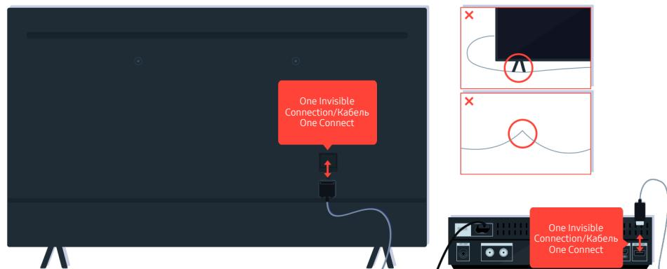
Отсоедините и снова подсоедините One Invisible Connection или Кабель One Connect, которым телевизор подключен к приставке One Connect. Убедитесь, что One Invisible Connection или Кабель One Connect не защемлен и не перегнут.
