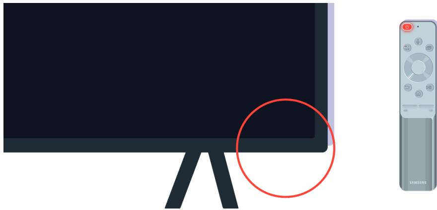
Если при нажатии кнопки питания датчик пульта ДУ отключается, телевизор подключен к источнику питания правильно.
