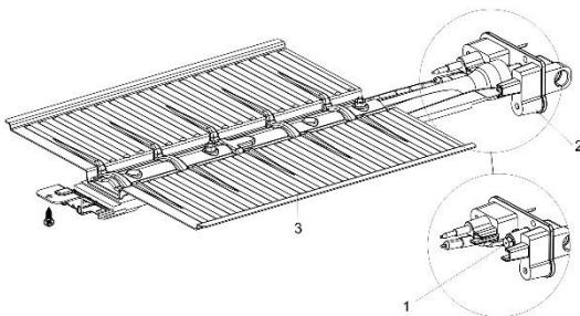
При настройке инфрагорелки на другой вид газа снимите инфрагорелку (открутите винт в передней части инфрагорелки и немного потяните инфрагорелку вперед).
