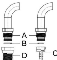
**A** Трубка газопровода EN ISO 228-1
