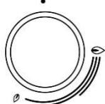
Мощность нагрева обозначена на переключателях символами большого и малого пламени. Вращайте переключатель через положение большого пламени (●) до положения малого пламени (○) и обратно. Рабочее положение находится между символами большого и малого пламени.
