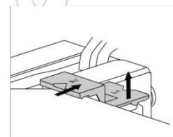
Немного приподнимите фиксаторы с левой и правой стороны дверцы (символ 1 на фиксаторе) и потяните в стороны от стекла (символ 2 на фиксаторе).
